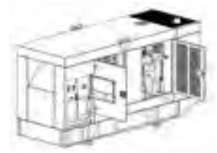
Diseño de la carrocería insonorizada de alta calidad
